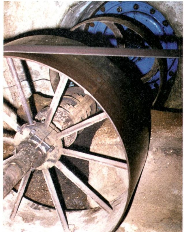
Durchgehende, mehrfach gelagerte Haupttransmissionswelle, die direkt mit Turbine 1 gekuppelt ist. Über die grosse Riemenscheibe kann die Anlage mit dem Elektromotor angetrieben werden, falls die Wasserführung der Lutern ungenügend ist. Die zweite Riemenscheibe treibt den Vollgatter an. Über die dritte Scheibe (mit den geschweiften Armen) kann die Hauptwelle mit der Turbine 2 gekuppelt werden, was den Verbundbetrieb ermöglicht.
