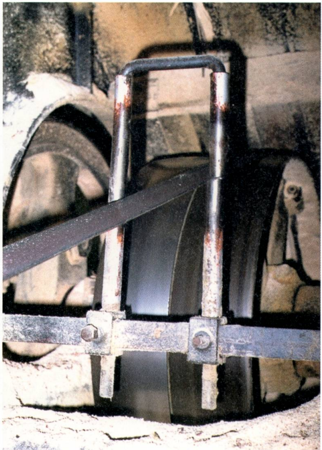
Riemenscheibe mit Leerlaufscheibe auf der Welle zwischen den beiden Exzenter-Schwungrädern. Der Riemen kann mit einer Spindel vom Sägegeschoss aus verschoben werden.
