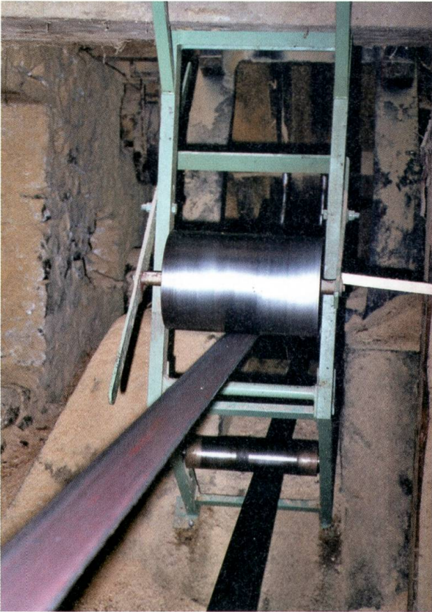
Spannrolle des Vollgatterantriebes.
