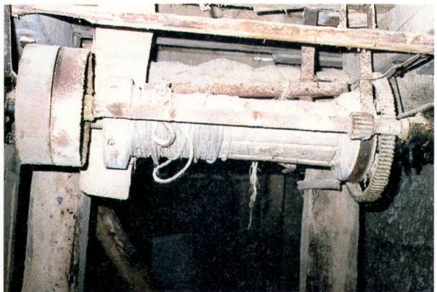
Diese über die Transmission angetriebene Seilwinde diente vermutlich zum Aufziehen des zu sägenden Rundholzes auf einer Rampe.
