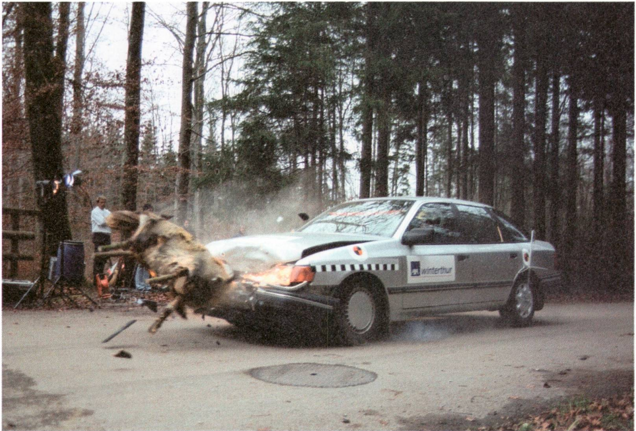
Ausserhalb der Wildhauser Crash-Kampagnen sind ab und zu Fachwissen und Erfahrungsschatz der Unfallforscher gefragt. Kollision mit einem Wildschwein-Dummy bei 70 Kilometern pro Stunde: Totalschaden. Foto: AXA Accident Research.
