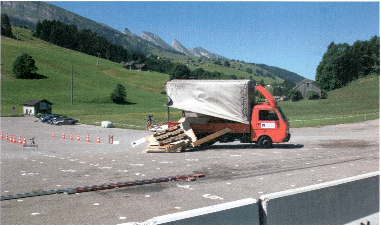
Zur Sensibilisierung und für Schulungszwecke werden in Wildhaus auch verschiedenste Filmsequenzen produziert. Die Folgen der ungenügenden Ladungssicherung sind beeindruckend. Foto: AXA Accident Research.
