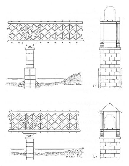
Das Prinzip der Brückenkonstruktionen nach Howe:
