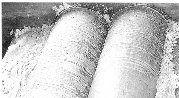
Walzen der Zigmühle, deren Abstand verstellbar ist.
