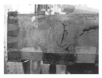
Detail Windlade: von Löschwasser und Hitze verzogene und gerissene Eckverbindung. Bild: Archiv Orgelbau Stemmer AG, Zumikon.
