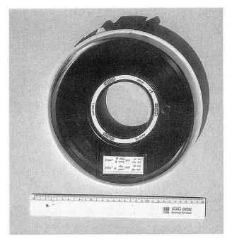
Die 1/2-Inch Bandspulen standen während rund 40 Jahren im Einsatz. Mit einer Bandlänge von 3600 Fuss und einer Schreibdichte von 6250 Bytes pro Inch konnte damit zuletzt eine Datenmenge von 270 MByte gespeichert werden.
