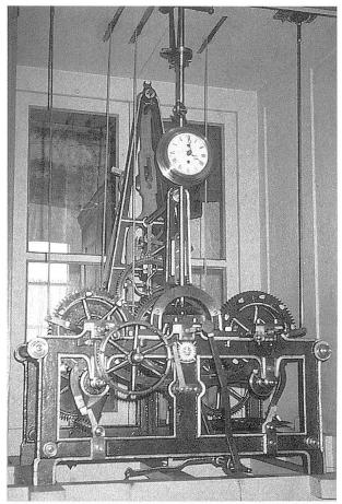
Verbund von einst 14, heute immerhin noch 11 funktionierenden Uhren. Das zentrale Uhrwerk erschliesst jede einzelne von ihnen über ein ausgeklügeltes System von Gestänge und Seilzügen in einer Gesamtlänge von rund 150 Metern!
