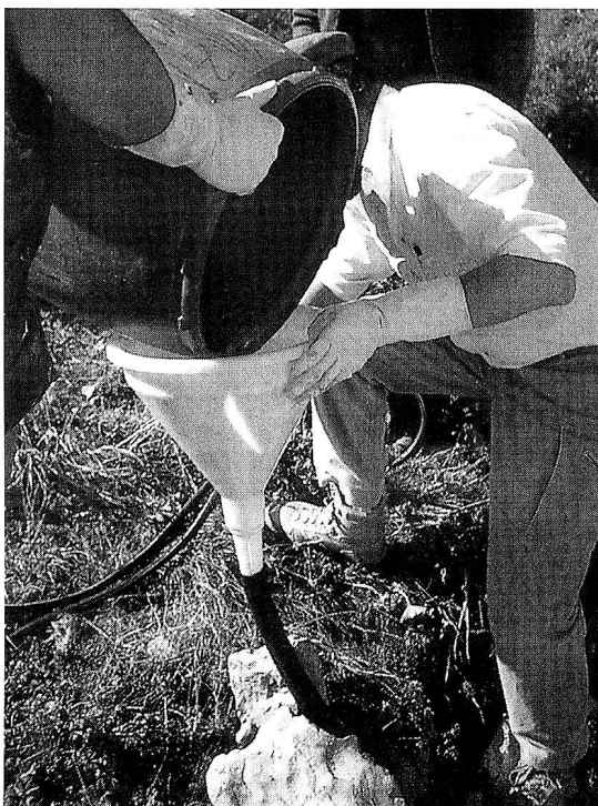
Einspeisung eines Markierstoffs in eine Schwinde auf einer verkarsteten Hochfläche.
