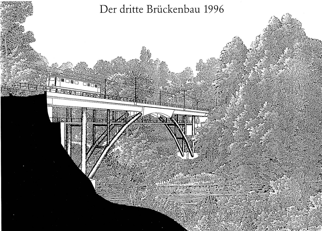
Die Projektskizze dokumentiert die Stahl-Beton-Verbundbrücke über die Glatt. Nach weiteren Projektüberarbeitungen kommen nun endgültig Betonbogen zur Ausführung. – Zeichnung: zVg.
