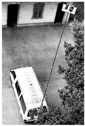
Für die Fotos aus der Höhe wird die Kamera auf eine Teleskop-Antenne montiert. Die montierte Kamerawippe mit integriertem Video liefert das Kontrollbild in den Messwagen.
