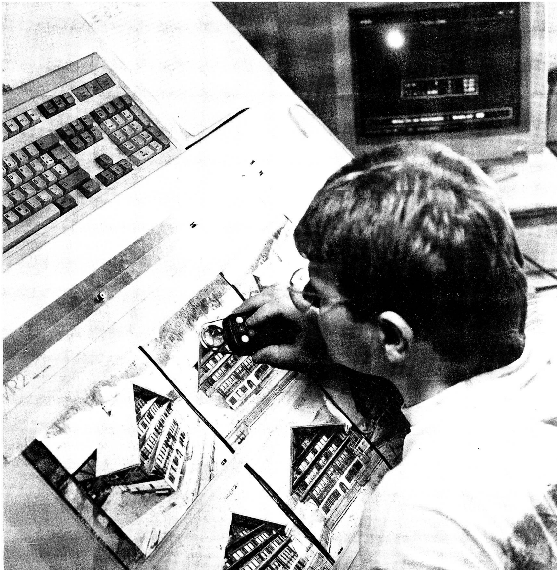
Mann am Computer. Auswertung der Bilder am Computer. Mit dem Messlupensensor werden die Messkreuze eingelesen. Automatisch entsteht eine dreidimensionale Darstellung des Hauses.
