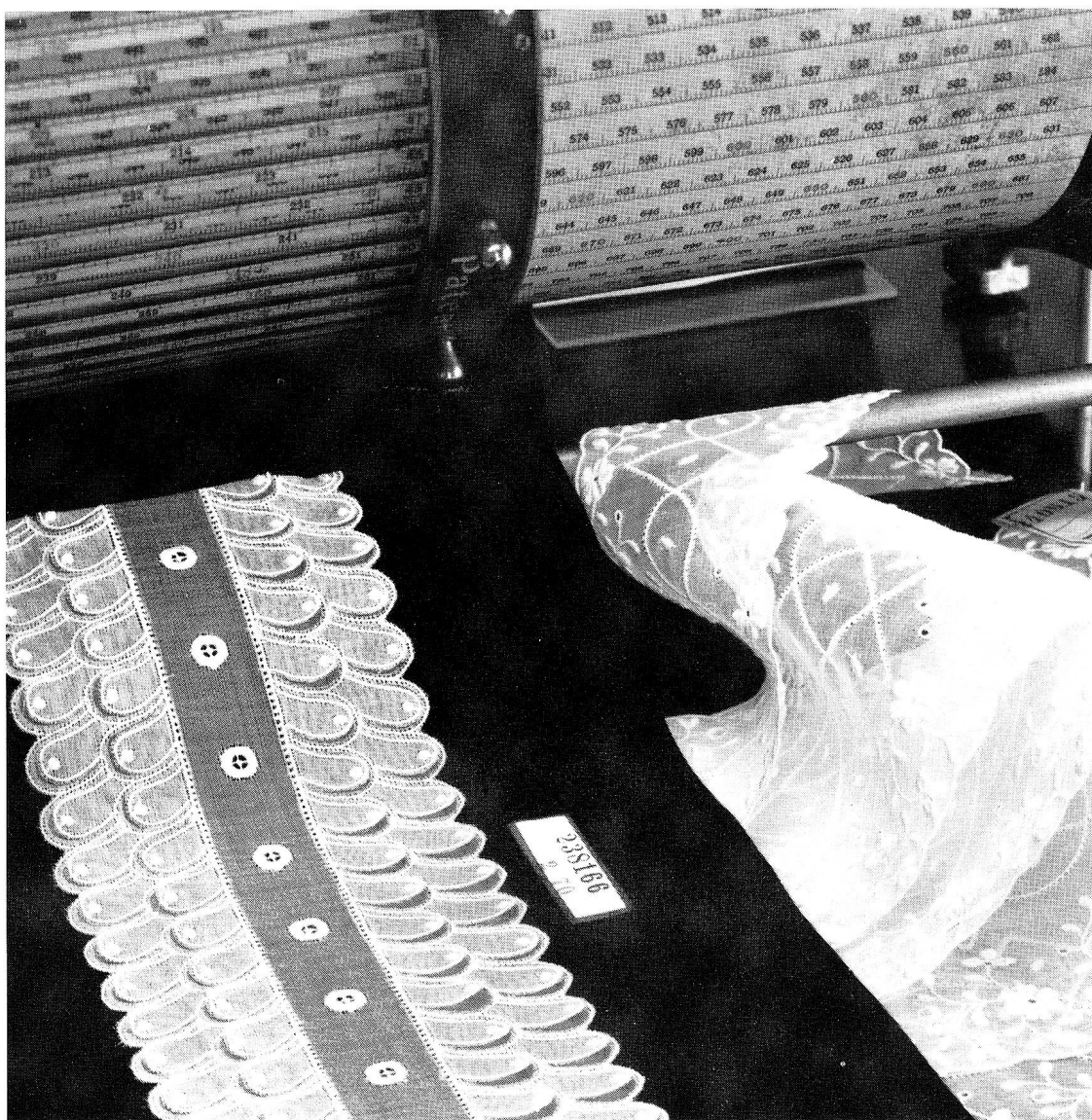
Maschinengestickte Bordüren. Dahinter eine «Calculator-Rechenwalze», die bei der Stickereifirma A. Naef AG, Flawil, bis etwa 1960 im Einsatz stand. Der «Calculator» beruht auf dem Prinzip des Rechenschiebers. Mit seiner Hilfe konnte man den Stichpreis ermitteln und damit den Meterpreis des bestickten Stoffes berechnen.
