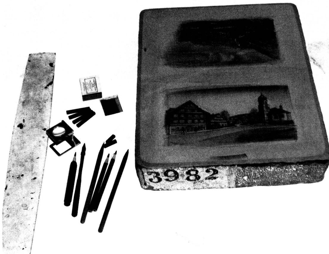
Druckstock aus Stein und Werkzeuge des Lithographen.
