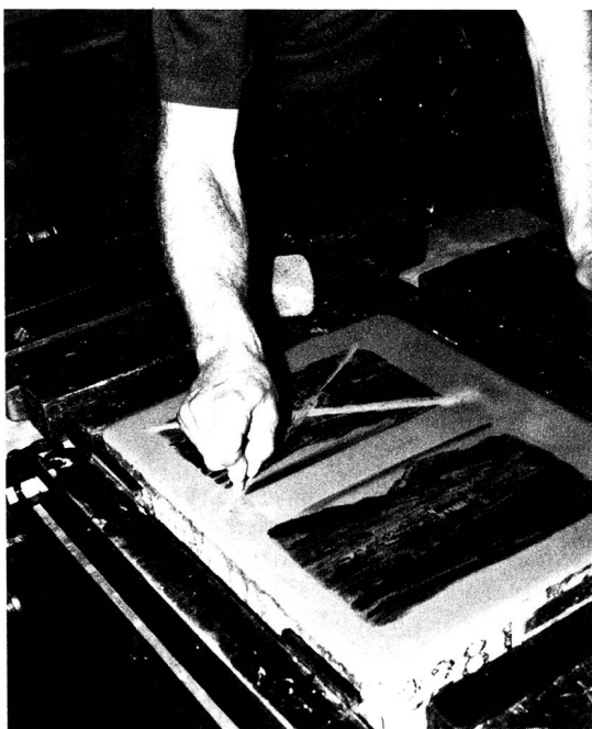
Nach Druck der gewünschten Auflage wird das Bild auf dem Stein zerstört, damit später keine Nachdrucke erstellt werden können. (Die Toggenburger Bilder erscheinen z. B. in einer Auflage von nur 100 Exemplaren pro Ansicht.)
