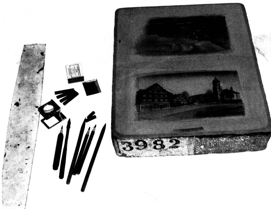
Druckstock aus Stein und Werkzeuge des Lithographen.
