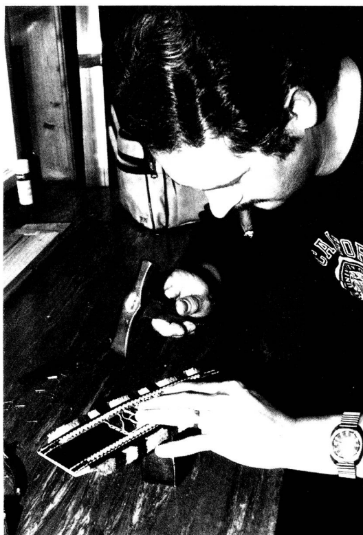
Die einzelnen Messingteile werden mit kleinen Messingstiften am Leder befestigt.
