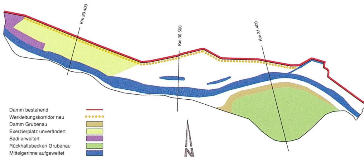
Abbildung 1: Konzeptschema Variante «Grubenau» (stehende Retention)
