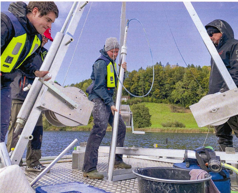
Abbildung 4-1: Oben: Beprobungsplattform auf dem Bichelsee Unten: Absenken der Kernkammer des Kolbenlots mit darin enthaltenem Plastik-Liner ins Wasser (Fotos: Geoökologie Universität Basel, Colin Courtney-Mustaphi).
