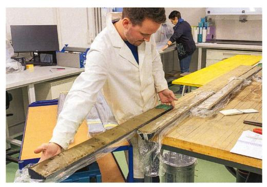
Abbildung 1-4: Korrelation der Bohrkerne durch Fabian Rey im Labor der Geoökologie in Basel (Foto: Geoökologie Universität Basel, Colin Courtney-Mustaphi).
