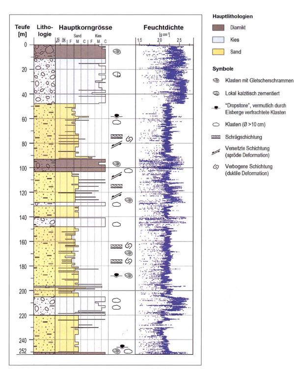
Abbildung 6: Erbohrte Sedimentabfolge, vereinfacht nach Schaller et al. (eingereicht).
