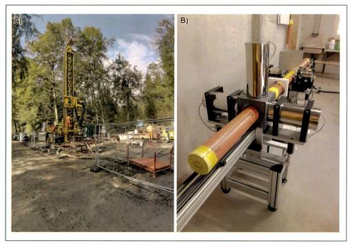
Abbildung 5 A): Der Bohrplatz im Wald bei Muedihaa mit dem Bohrgerät (gelb). B): Die Bohrkerne werden in Plastik-Linern (1 m lange orange Rohre) gebohrt und durchfahren nach dem Bohren eine Messbank zur Bestimmung von P-Wellengeschwindigkeit, magnetischer Suszeptibilität und Dichte. Die erbohrten Sedimente werden erst später im Labor sichtbar, wenn die Liner aufgeschnitten werden. Foto: Sebastian Schaller.
