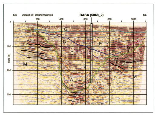
Abbildung 4: Seismisches Profil über den Bohrpunkt der Forschungsbohrung in Basadingen-Schlattingen (ICDP site 5068\_2). Die grüne Linie markiert die vermutete Basis der Übertiefung über den Gesteinen der Molasse (M). Die Füllung der Übertiefung ist in mehrere seismisch unterscheidebare Sedimentpakete (A bis G) gegliedert. Die Kombination von Seismik und Bohrkernen erlaubt eine detaillierte Interpretation der Füllung der Übertiefung.
