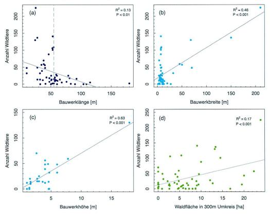
Abbildung 10: Anzahl der querenden Wildtiere in Abhängigkeit der Bauwerksparameter (a) Länge, (b) Breite und (c) Höhe sowie (d) des Umgebungsparameters Waldfläche in 300 m Umkreis. Die graue Linie zeigt die Regressionsgerade.
