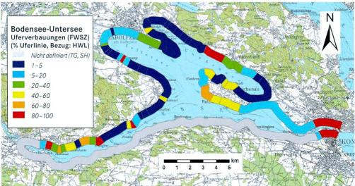
Abbildung 14: Flachwasserschutzzonen am baden-württembergischen Unterseeufer; oben Lage der Flachwasserschutzzonen FWSZ I und II sowie der aFWZ (schem., Erläuterungen s. Text); unten Verbauungsgrad der Flachwasserschutzzonen (% verbaute Uferstrecke, Bezugslinie HWL). Reproduziert mit Bewilligung von swisstopo (BA 140317).
