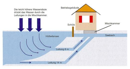
Abbildung 7: Schematischer Querschnitt der Tiefenwasserableitung.
