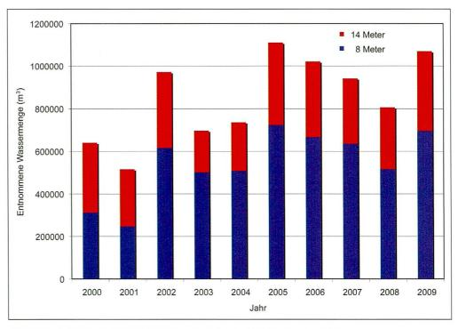
Abbildung 9: Entnommene Wassermengen seit Inbetriebnahme der TWA.
