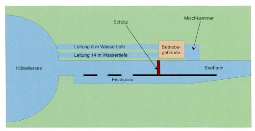
Abbildung 6: Die Anlagenteile der Tiefenwasserableitung in schematischer Übersicht.
