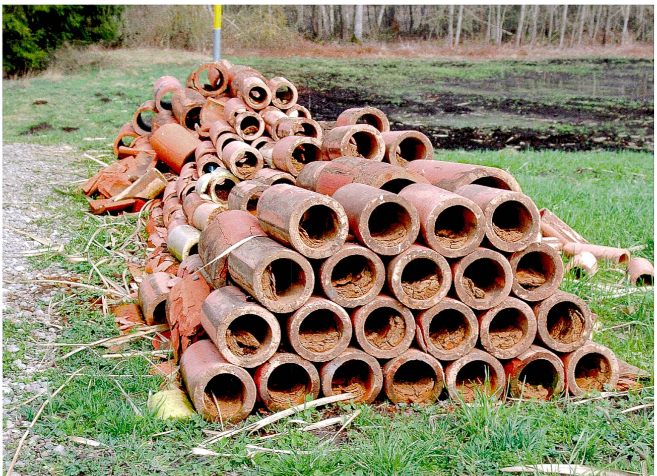
Abbildung 1: Ausgegrabene Drainageröhren. (Foto: Joggi Rieder)
