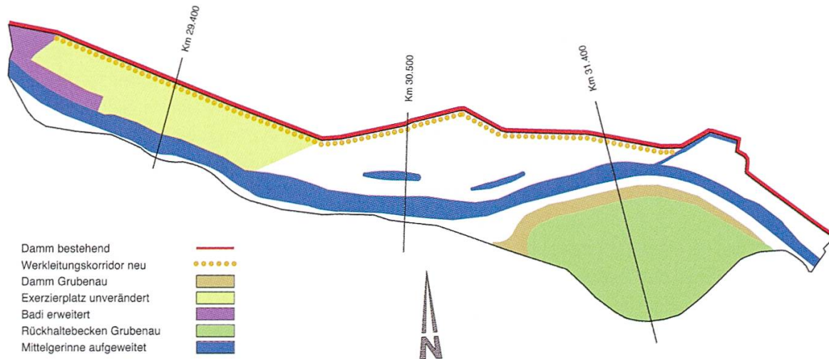
Abbildung 1: Konzeptschema Variante «Grubenau» (stehende Retention) Fließrichtung Thur von rechts nach links. Das obere Ende des Projektperimeters bildet die Istighoferbrücke, das untere Ende die Rothenhauserbrücke resp. das Wehr «Model-Meyerhans». Nach Norden begrenzt der bestehende Hochwasserdamm den Projektperimeter.
