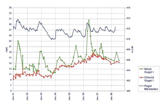
Abbildung 5: Grundwasser des PW Gugel I, Nitrat- und Chlorid-Gehalte zwischen 2001 und 2008 sowie Pegelwerte der Messstelle Märstetten.
