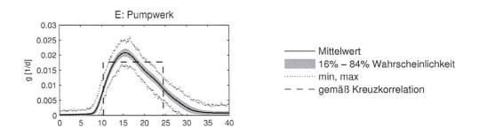
Abbildung 2: Ermittlung der Fliesszeit-Verteilung im Pumpwerk Widen III mittels formfreier Dekonvolution.  $\tau$ , Fliesszeit;  $\rho(\tau)$ , Transfer-Funktion (Impuls-Response). Durchgezogene Linie, Mittelwerte von 2000 Realisationen; graue Streifen, Bereich, in den 68% der Realisationen fallen; gestrichelte Linien, Minimum und Maximum der Realisationen; Kreuze, bester Schätzwert; übersetzt aus Cirpka et al. (2007).
