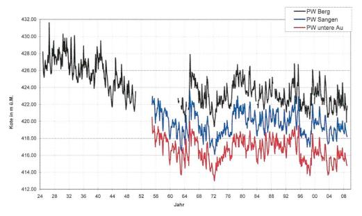
Abbildung 5: Ganglinien des PW Bürglerfeld (Berg), PW Sangen (Weinfelden) und PW Untere Au (Weinfelden), PW=Pumpwerk.
