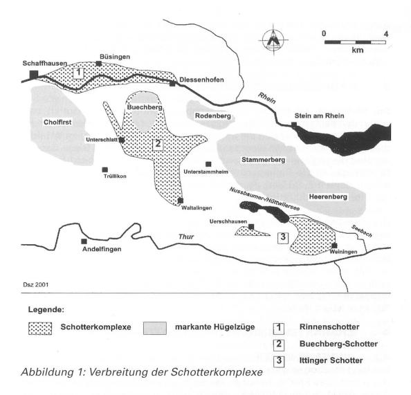
bildet der anstehende Fels der OSM an der Kette Heerenberg-Stammerberg-Rodenberg eine klare Begrenzung eines in die Molasse eingeschnittenen alten Tales, das in SE-NW-Richtung streichend das Thurtal mit der Rheinrinne verbindet.
