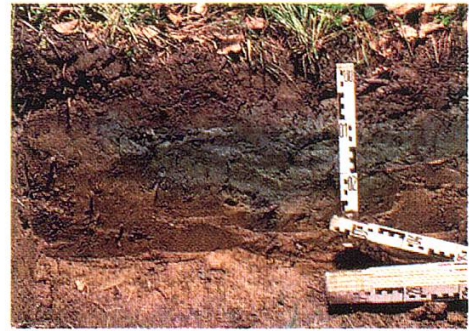
Unter einer Radspur verdichtete Zone, mit mangelnder Durchlüftung, erkennbar an der bläulich grauen Farbe
