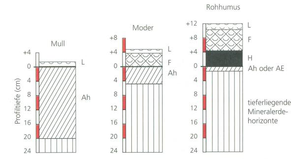
Abbildung 5: Schematischer Aufbau der drei wichtigsten, typischen Humusformen
