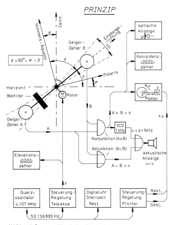
Abbildung 1: Gammastrahlenteleskop, Prinzipschaltung.
