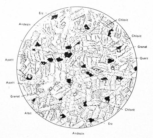
Ausmessung und Zählung ergaben in diesem Schliffe folgende prozentualen Anteile der Mineralien: Magnetit = 2%, Albit = 20%, Andesin = 30%, Anorthit = 20%, Biotit = 5%, Chlorit = 17%, Apatit = 3%, Quarz = 3%.
