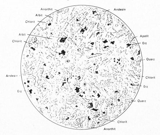
Bei der geringen Trübung der Feldspäte ist eine Bestimmung der Auslöschungswinkel keine schwierige Aufgabe. Ausmessung und Zählung im Schliff ergaben folgende prozentuale Anteile der Mineralien: Magnetit = 2%, Chlorit = 10%, Albit = 30%, Andesin = 40%, Anorthit = 17%, Quarz = 1%.
