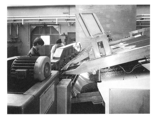
An der Spaltmaschine wird die Haut in ihrer Dicke gespalten Im grossen Gerbfass werden die gespaltenen Blössen gegerbt
