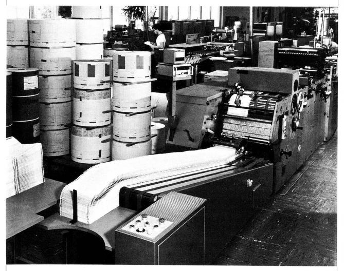
Collator für die Herstellung von Endlosformularen
