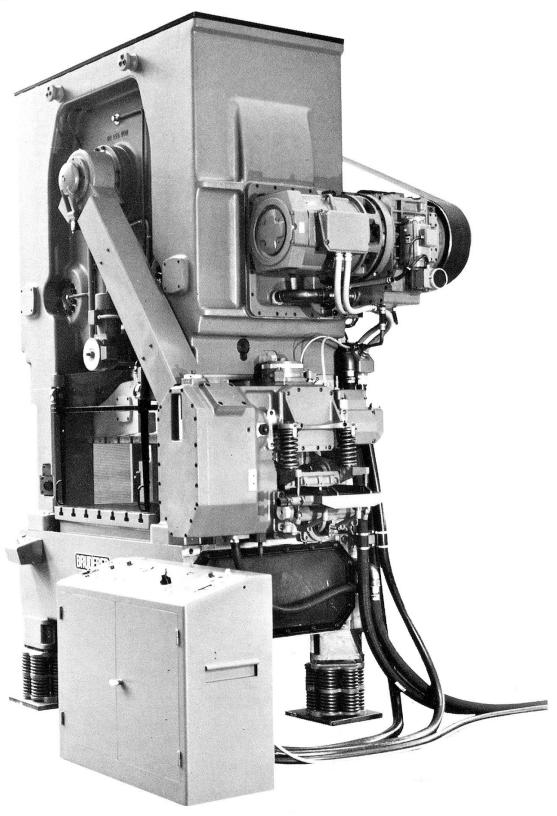
«Der neue BRUDERER BSTA 110 Stanzautomat erobert den Weltmarkt. Mit 110 t Stanzdruck erreicht er 850 Hübe/Minute – bis 108 m Band pro Minute werden auf dieser Maschine gestanzt».
