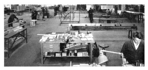
3. In der Metallbauabteilung werden Ganzglastüren mit den nötigen Beschlägen versehen und die Rahmenkonstruktionen für Schaufensteranlagen angefertigt und zusammengebaut.
