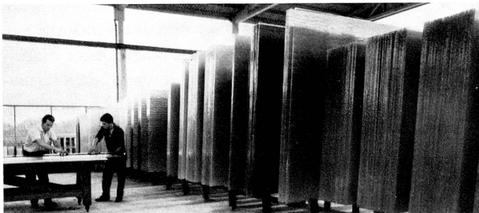
5. Praktische, neuartige Gestelle für die Lagerung von Draht- und Rohglas erlauben ein zeitsparendes Zuschneiden.
