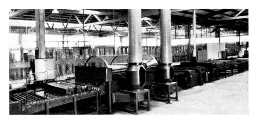
4. Die Tagesleistung des automatischen Spiegelbelegbandes beträgt rund 450 Quadratmeter und wird von drei Arbeitskräften bedient.
