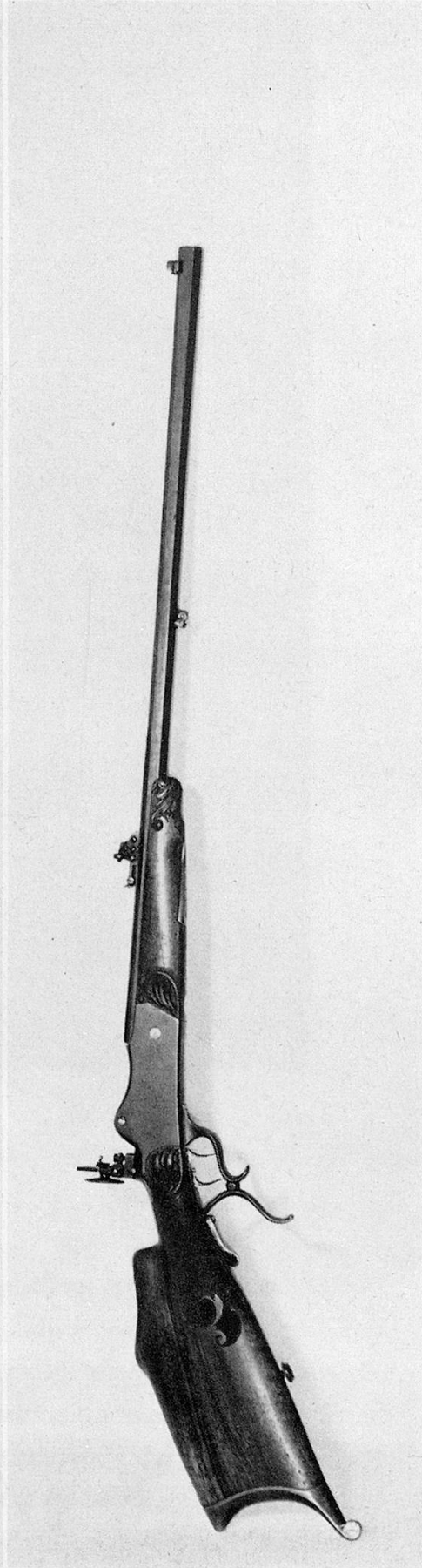
Martini-Matchstutzen, um 1920 Kaliber 7,65 mm, 4 Züge Lauf signiert V Kern in Nürnberg (Prüfmarke V mit Krone) Dioptervisierung
