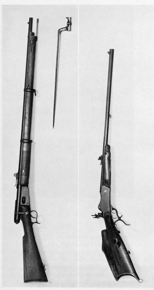
Vetterligewehr, Ordonnanz, 1872 Kaliber 10,4mm, 4 konzentrische Züge Visierstellung auf 1000 m Zylinderdrehverschluß, Serie 110092 Soc. Ind. Suisse (SIG) Verschiedene Prüf-und Herstellermarken
