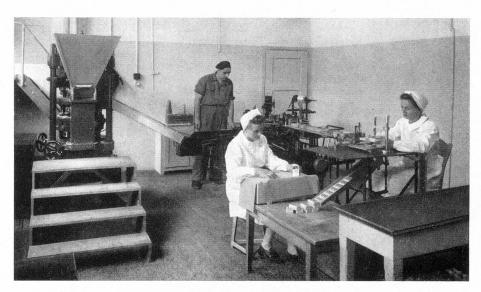
Automatische Abfüll- und Einwickelmaschine, System SIG, für die Fabrikation von Rekord-Suppenwürfeln
