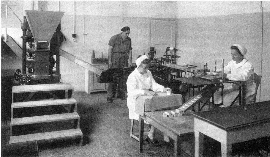
Automatische Abfüll- und Einwickelmaschine, System SIG, für die Fabrikation von Rekord-Suppenwürfeln
