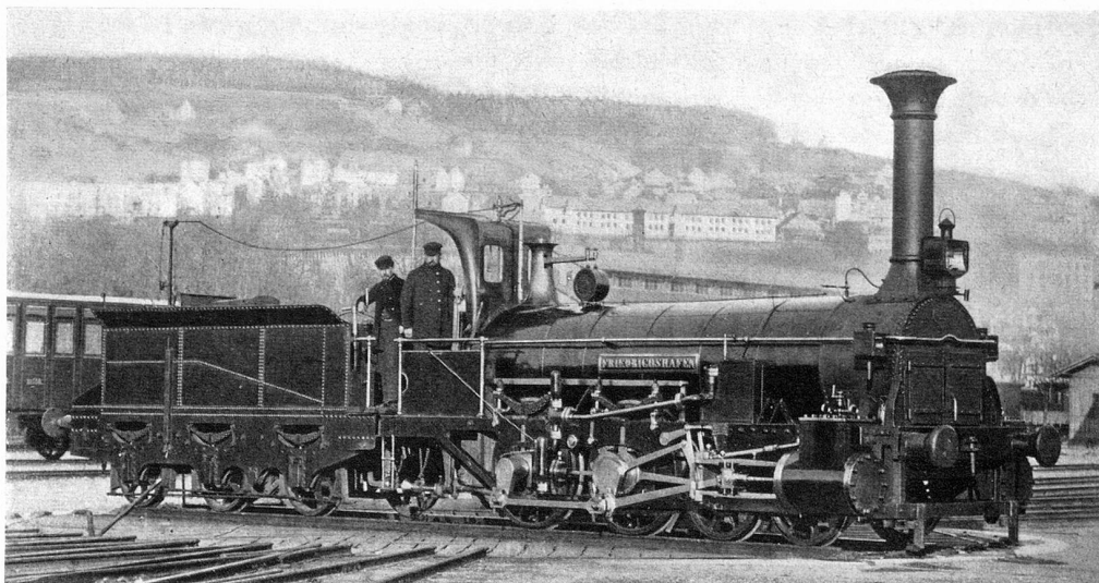
Die Lokomotive «Friedrichshafen» von J.A.Maffei in München 1854 erbaut, die die ersten Güterzüge nach Romanshorn brachte
