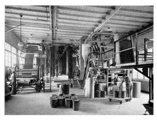
Die Fabrikation: Rechts die unbearbeiteten Papierrollen; hinten in der Mitte die Trockenanlage; links das Aufrollen des farbigen Schleifpapieres oder Schleiftuches
