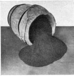
Der Rohstoff: Links rohe Steine, bereit zur Zerkleinerung in Schleifkörner; rechts ein Faß voll künstliche Schleifkörner
