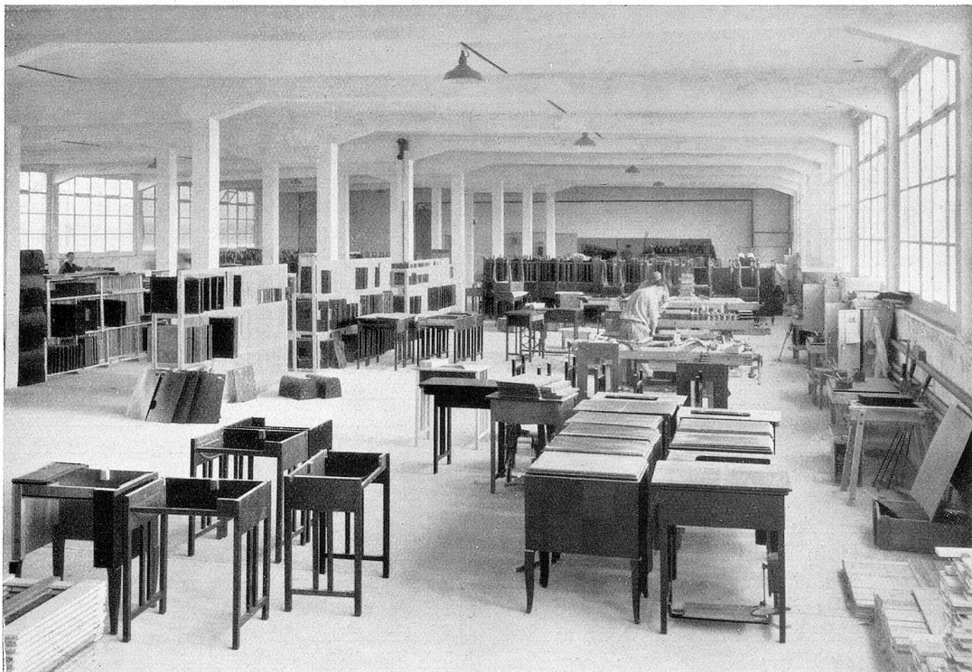
Montage der Nähmaschinenmöbel
