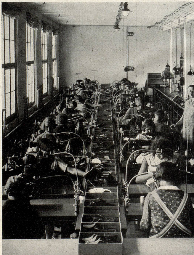
Spezial-Abteilung im Nähereisaal der Schuhfabrik Löw A. G. - Das letzte Wort in der neuzeitlichen Schäftenäherei: Die Fließbandarbeit
