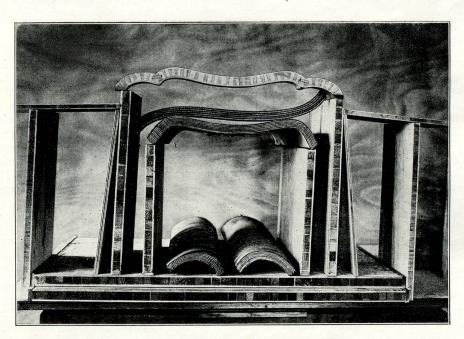
Moderne, abgesperrte Möbelkonstruktion (Bild 5)
