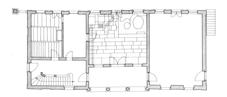
Das Blumenhaus von Schloss Münsingen. Ansicht der Südfassade, Rekonstruktion des Zustands um 1790 mit den je dreiachsigen Abschnitten, oben. Rekonstruktion des Grundrisses des Erdgeschosses, unten. Nicht massstäbliche Verkleinerung. Atelier Bellwald + Partner AG.
