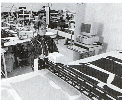
Abb. 5: Einzellagencutter für den Individualzuschnitt
