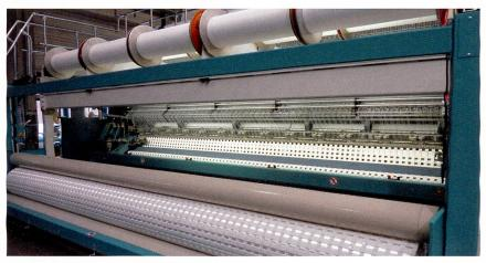
Abb. 1: Die RS MSUS-V bei der Produktion der starken Geogitter
