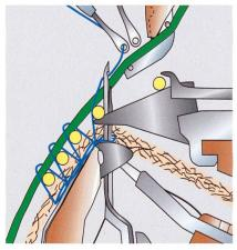
Abb. 3: Wirkwerkzeuge der RS MSUS-V bei der Vliesverarbeitung
