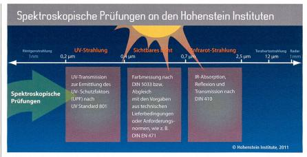
Abb. 3: Spektroskopische Prüfungen
