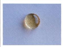
Abb. 2: Nano-funktionalisierte Textilien weisen Wasser und Schmutz ab
