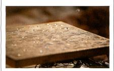
Abb. 6: Messplatte des Hautmodels
