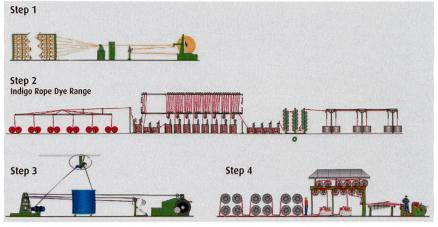
Abb. 2: Ablauf des ROPE-DYEING-Prozesses
