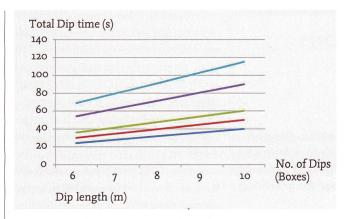
Abb. 3: INDIGO-Färbezeit in Abbängigkeit von der Anzahl an Färbebädern und der Verweilzeit
