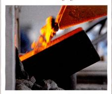
Abb. 1: Gesteinsschmelze, fotografiert beim Hersteller DBF Deutsche Basalt Faser GmbH, Sangerhausen. Foto: TuW/TEXSALT
