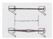
Abb. 6: Prüfung der Schlingenfestigkeit von Nähfäden, Quelle: Gütermann
