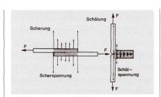
Abb. 7: Schär- und Schälspannungen
