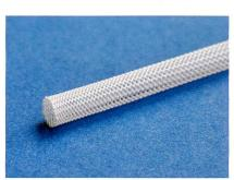
Abb. 1: Tubuläre Gewirkestruktur aus PLLA – Einsatz als Scaffoldstruktur
