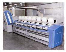
Abb. 5: Die neue Toyota-Truetzschler Kämmmaschine TCO 12
